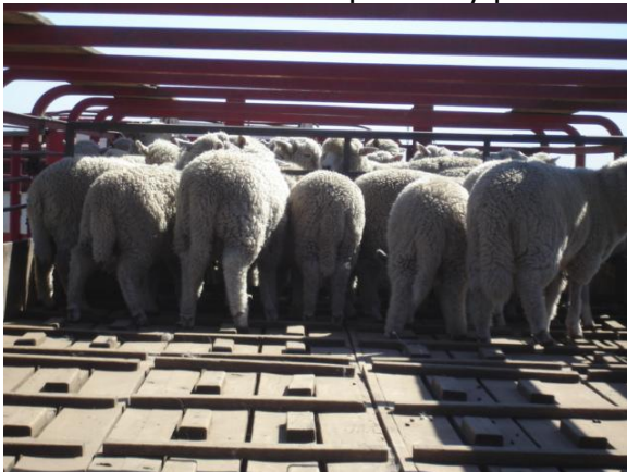
Foto 44b. Camión con separador y piso con trabas antideslizantes
